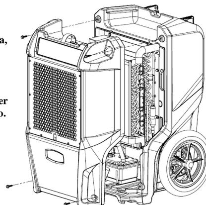
**Limpie las bobinas:** inspeccione la bobina evaporadora horizontal (frío) sin la cubierta del frente. Si observa una cantidad excesiva de polvo y suciedad, aspire bien o limpie con un limpiador para bobinas.
