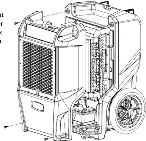
la pompe et le bac de la pompe doivent être nettoyés. Cela nécessite le retrait du logement avant.
